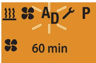
Режим отображения для воздухонагревательных приборов при продолжительной работе в режиме ВЕНТИЛЯЦИЯ (Заводская настройка).
