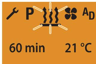
Режим отображения для воздухонагревательных приборов при продолжительной работе в режиме обогрева (заводская настройка).
