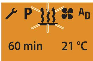
Режим отображения для воздухонагревательных приборов при продолжительном режиме отопления.
