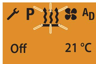
После появления сообщения ОБОГРЕВ OFF (Выкл) откроется стартовое окно. После ВЫКЛЮЧЕНИЯ светового оборудования автомобиля подсветка дисплея гаснет через 10 секунд.
