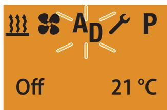
После появления сообщения ДОПОЛНИТЕЛЬНЫЙ ПРИБОР OFF (Выкл) отобразится стартовое окно. После ВЫКЛЮЧЕНИЯ светового оборудования автомобиля подсветка дисплея гаснет через 10 секунд.
